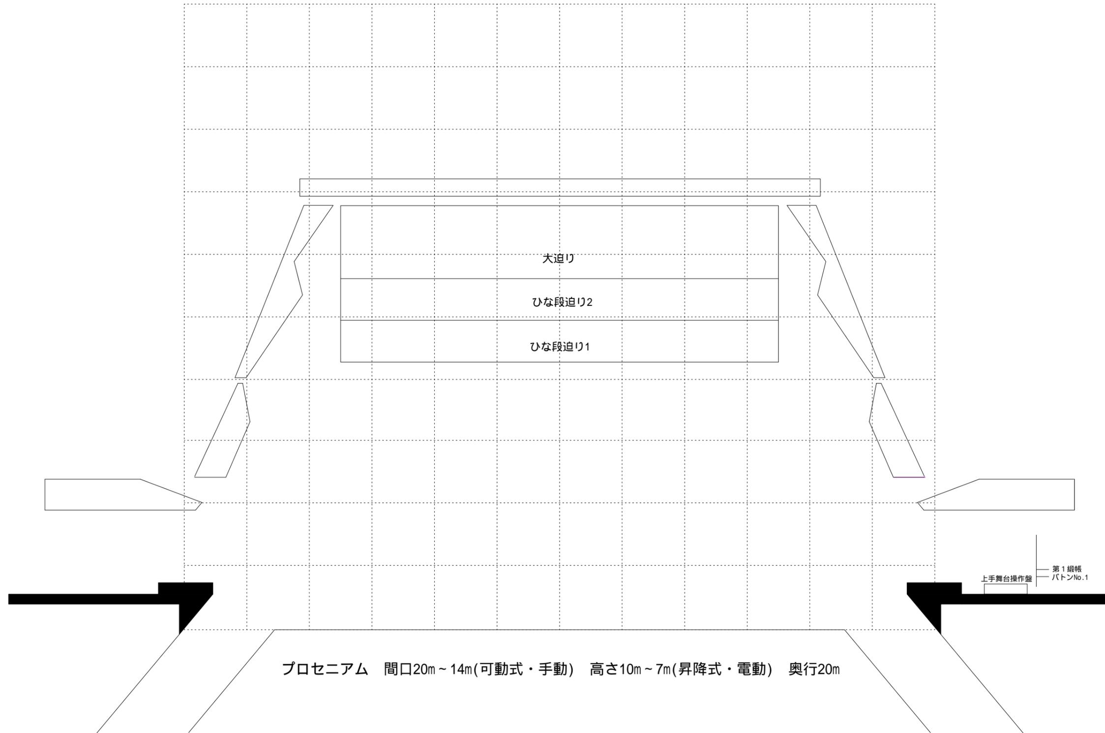
プロセニウム 間口20m~14m(可動式・手動) 高さ10m~7m(昇降式・電動) 奥行20m
